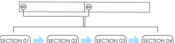
**i** IDENTIFY AND ARRANGE FIXTURES BY THEIR ID LABEL ON THE SIDE OF THE EXTRUSION BEFORE INSTALLATION
