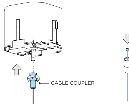
**2** GRID CEILING SUSPENSION - NON-POWER FEED
