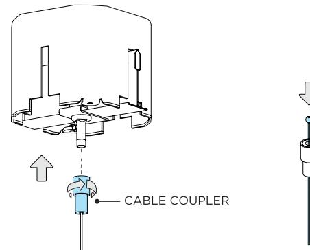
**3** GRID CEILING SUSPENSION - NON-POWER FEED
