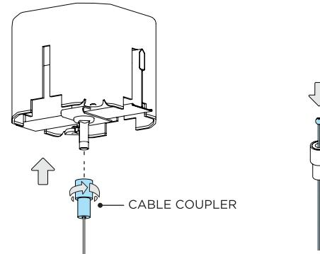
**3** GRID CEILING SUSPENSION - NON-POWER FEED
